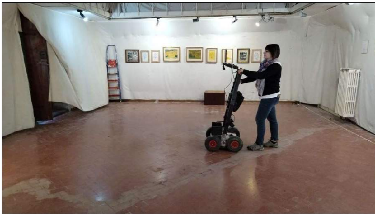
Realizzazione acquisizioni GPR
