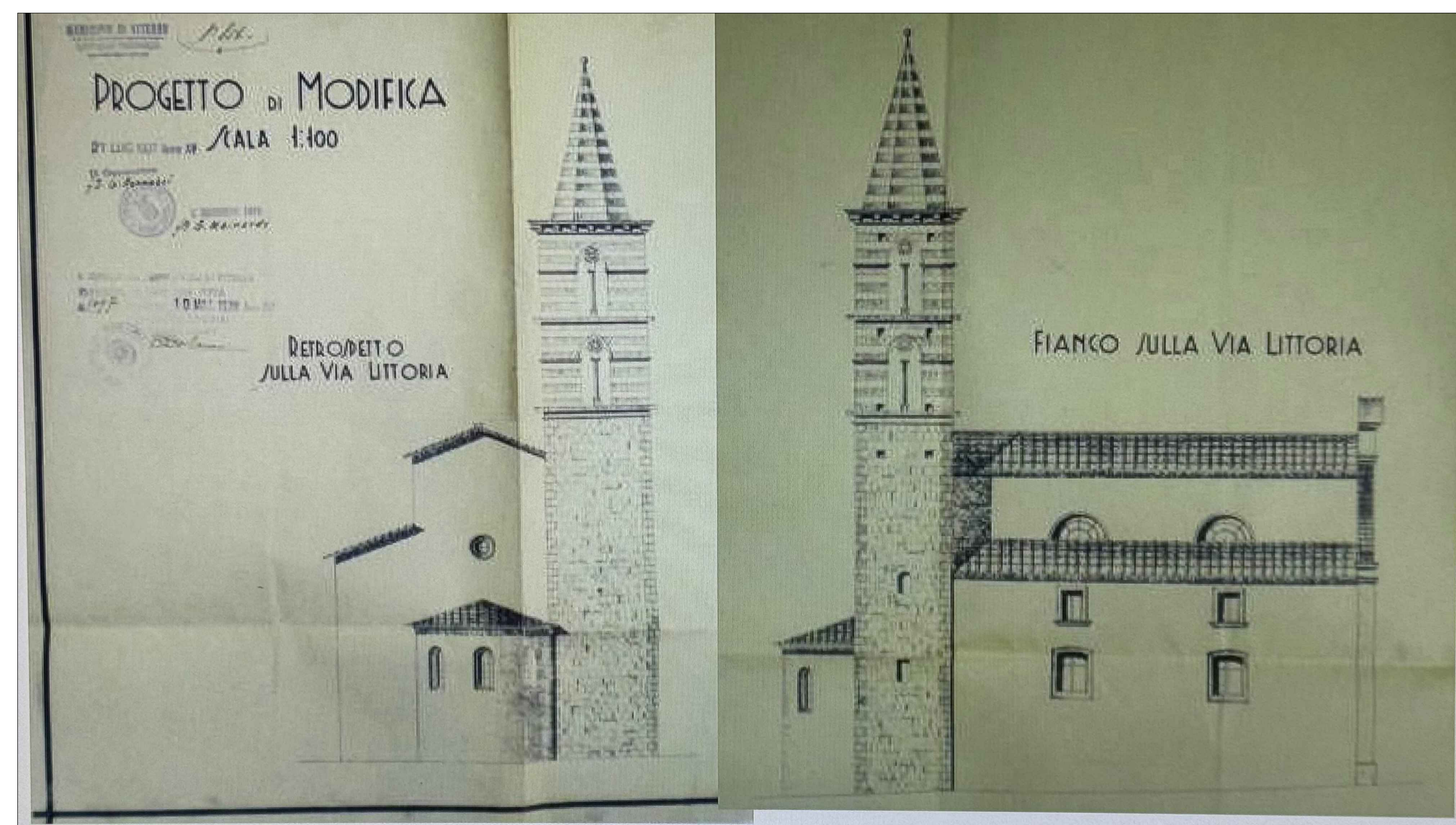
PROSPETTI DELLA CHIESA PROGETTO DI RICOSTRUZIONE CON ARRETRAMENTO DEL CAMPANILE E DELLA FACCIAIA CON LA PRESENZA DELL'ABSIDE RICOSTRUITO CHE RIMARRA' FINO AGLI ANNI '50 1937
