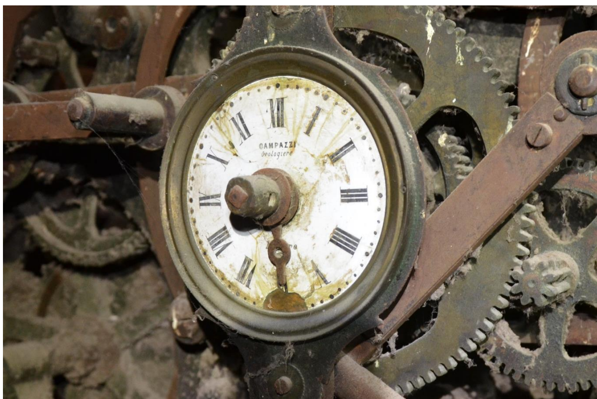
Fig. 39: Piccolo quadrante in ferro smaltato con il marchio della casa produttrice.
